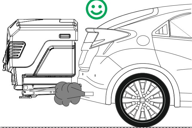
**ES** Atención a la salida directa de gases contra el material plástico del TowBox. Si queda demasiado cerca ¡NO MONTAR!. Utilice el kit de elevación con referencia TBB0019.
